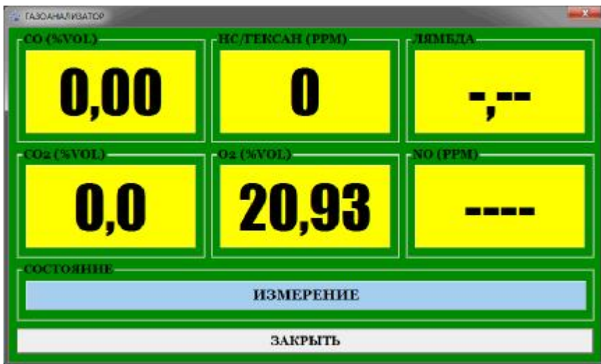
Рисунок 2. Окно данных газоанализатора.
