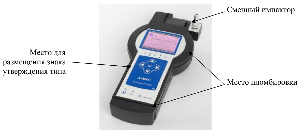
Рисунок 1 – Внешний вид анализатора пыли Атмас, обозначение места для размещения знака утверждения типа и схема пломбировки от несанкционированного доступа
